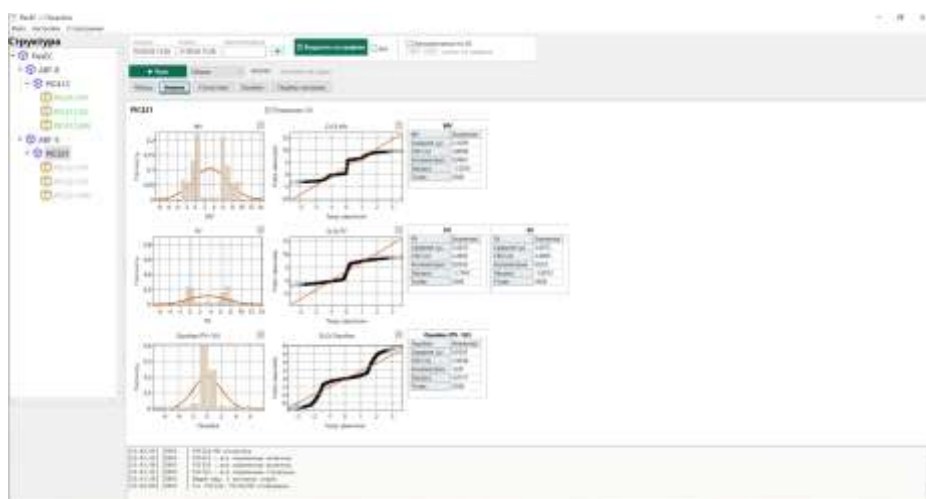
Вкладка «Анализ»: гистограмма ошибки с кривой Гаусса и Q-Q график.
