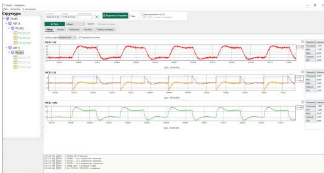
Вкладка «Обзор», режим «Раздельный»: три графика PV/SV/MV одного тега.
