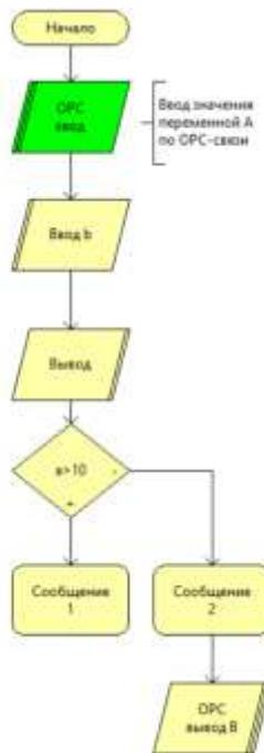
По ходу выполнения блок-схемы алгоритма в окнах ввода можно вводить входные данные. Для переменной «a» ввод данных должен быть выполнен через браузер сервера Prosys:
