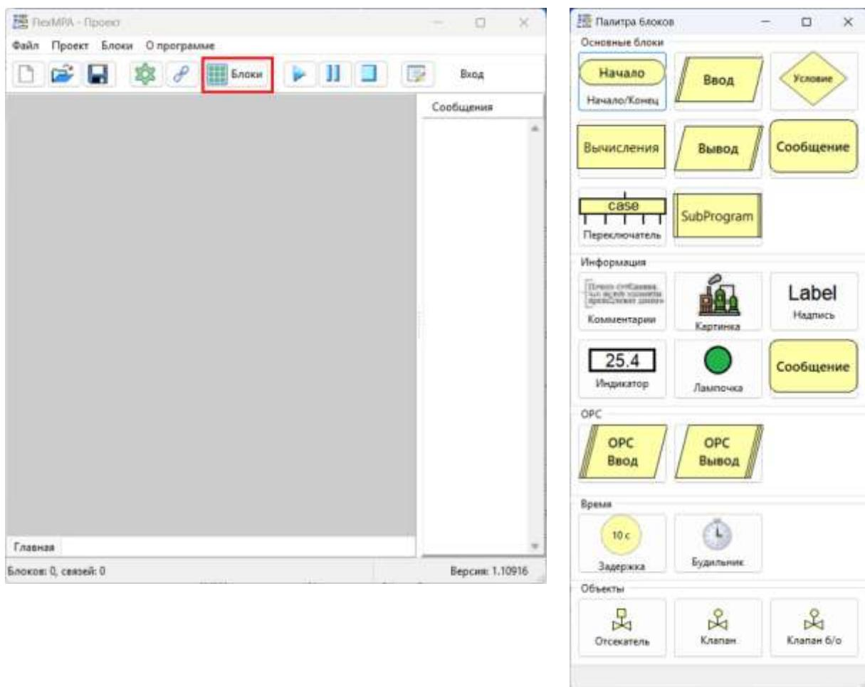
Для набора блок-схемы нужно последовательно вызвать соответствующий блок, переместить на свободное поле рабочей области и соединить их в соответствии с заданной последовательностью выполнения.
