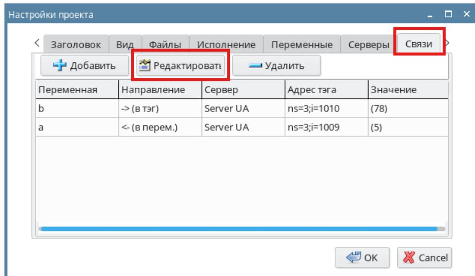
В открывшемся окне необходимо указать адрес тега OPC (как он обозначен в сервере Prosys для указанного примера), а также направление связи. Для переменной «а» - входная связь:
